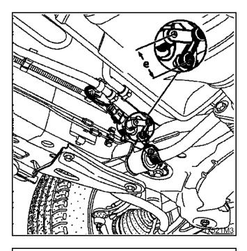
IMPORTANT: AT EACH SERVICING OPERATION ON THE FRONT OR REAR GROUND LINKAGE SYSTEM DISASSEMBLE THE LINKAGE FROM THE ANTI-ROLL BAR AND/OR THE TRANSVERSE GUIDE BAR.
